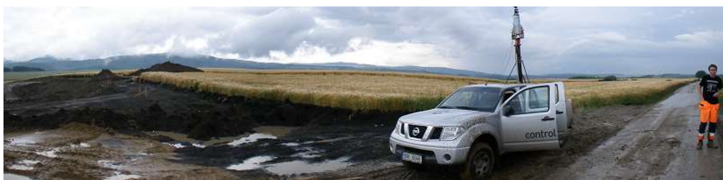
Obr. 5 – Měření 3D mobilní mapovací jednotkou. Nejvyšší garantovaná přesnost s vysokou hustotou bodů a dosahem až 1km.
