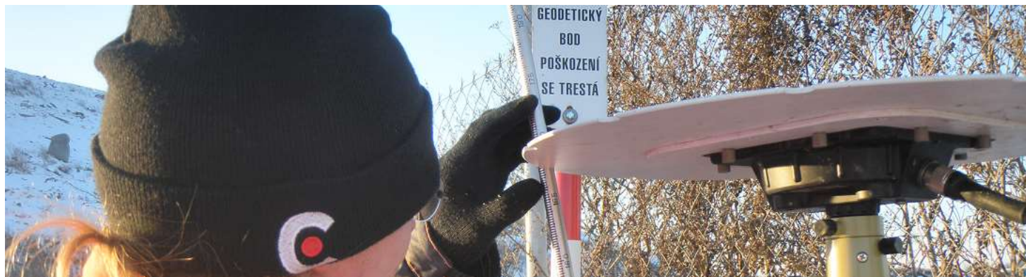
Obr. 4 – Měření je připojené na bodové pole stavby vlastní referenční stanici GPS. Připojení je ověřováno před každým měřením.
