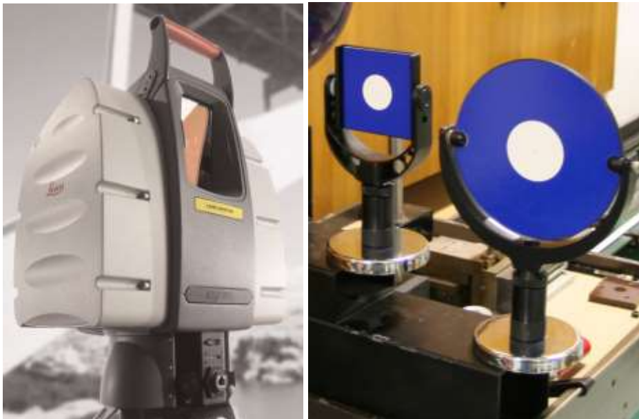
Obr. 1 – Skenovací systém Leica HDS3000 a vřícovací body
