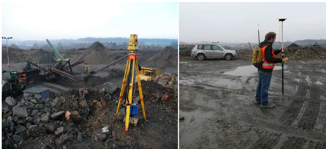
Obr. 4-6 Vlevo porouchaná totální stanice. Vpravo doměřování pomocí RTK
