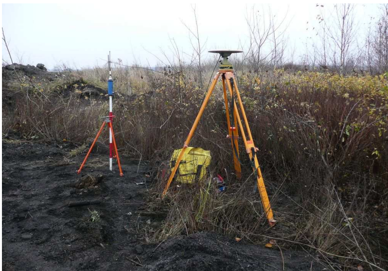
Obr. 4-2 Referenční stanice TRIMBLE (anténa Zephyr geodetic)
