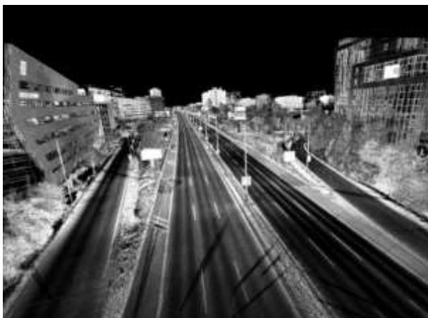
Obrázek 2: Základní výstup: 3D mračen bodů s detaily silnice a okolí
