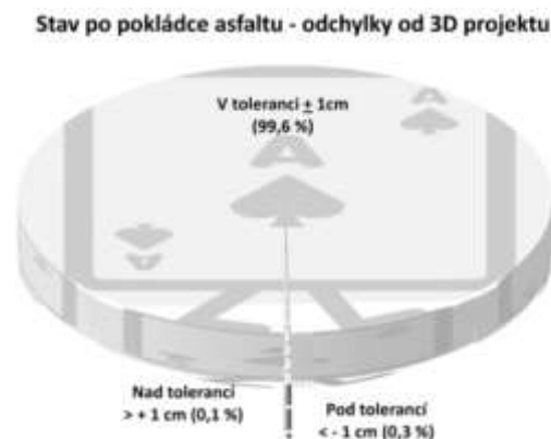
Graf 3: Z grafu PO POKLÁDCE ASFALTOVÉ VRSTVY, je patrné že se podařilo provést položení asfaltové vrstvy v toleranci s 3D projektem z 99,6%
