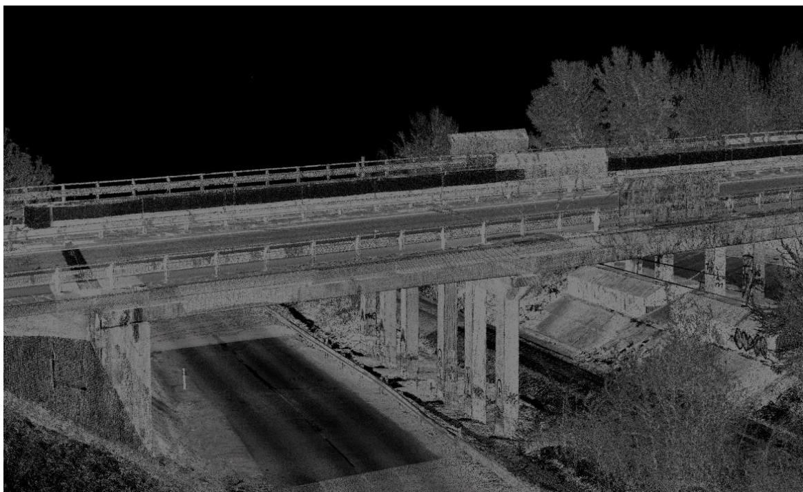
Obrázek 4: Základní výstup: 3D mračna bodů mostu
