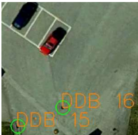
Ukázka vličovacích bodů použitých pro zpracování ortofotomapy
