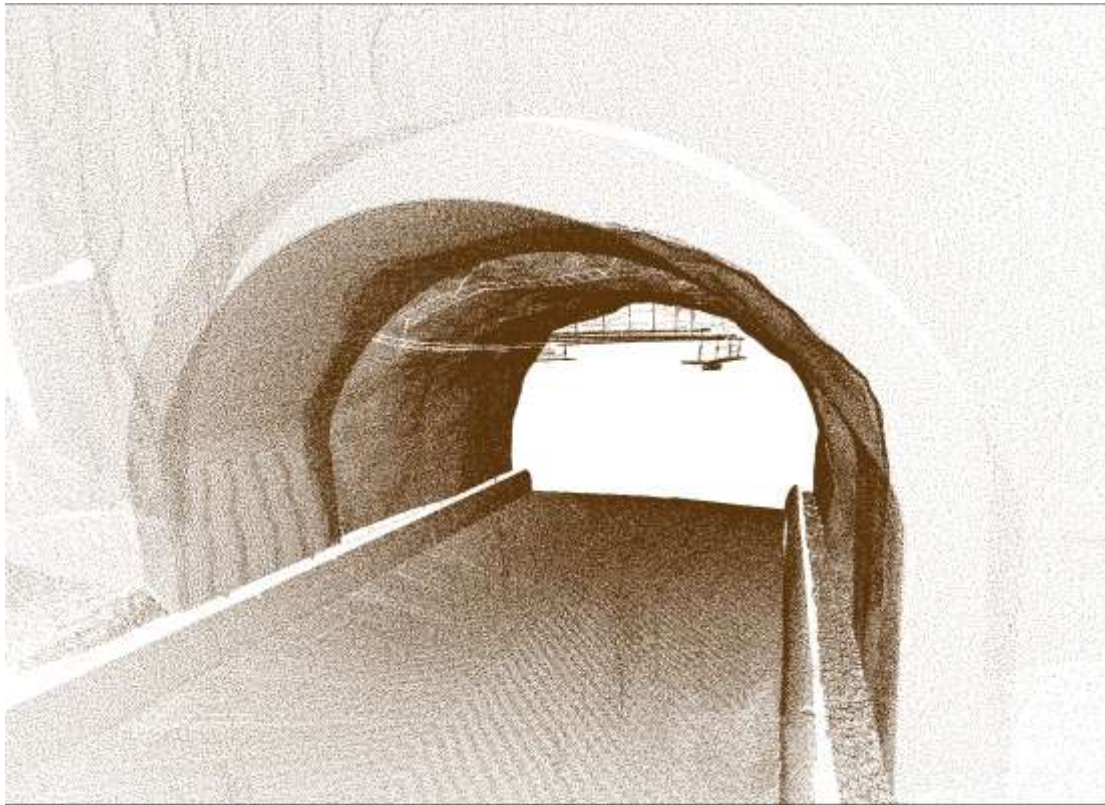
Obr. 4: Mračno bodů laserové skenování (zdroj: Control System)
