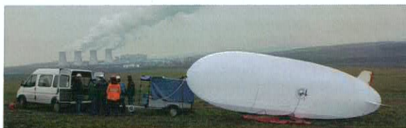
Obr.2: 12m dlouhá měřicí vzducholoď, která umožňuje laserové skenování, fotogrammetrické a termometrické snímkování
