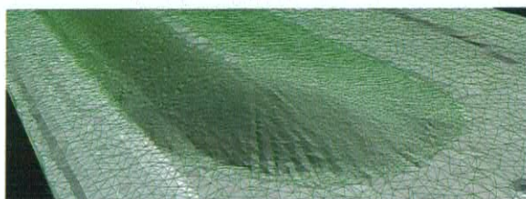
Obr.5: Výsledkem je digitální model terénu s garantovanou přesností s využitím například pro přesné výpočty kubatur
