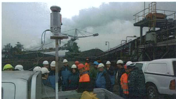
Obr.1: Skener Riegl připravený na vozidle pro „Stop & Go“ laserové skenování na homogenizační skládce uhlí v Tušimicích
