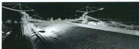
Obr.4: Základní výstup měření metodou stop & go laserového skenování skládky uhlí je mračno bodů s s průměrnou hustotou asi 500
