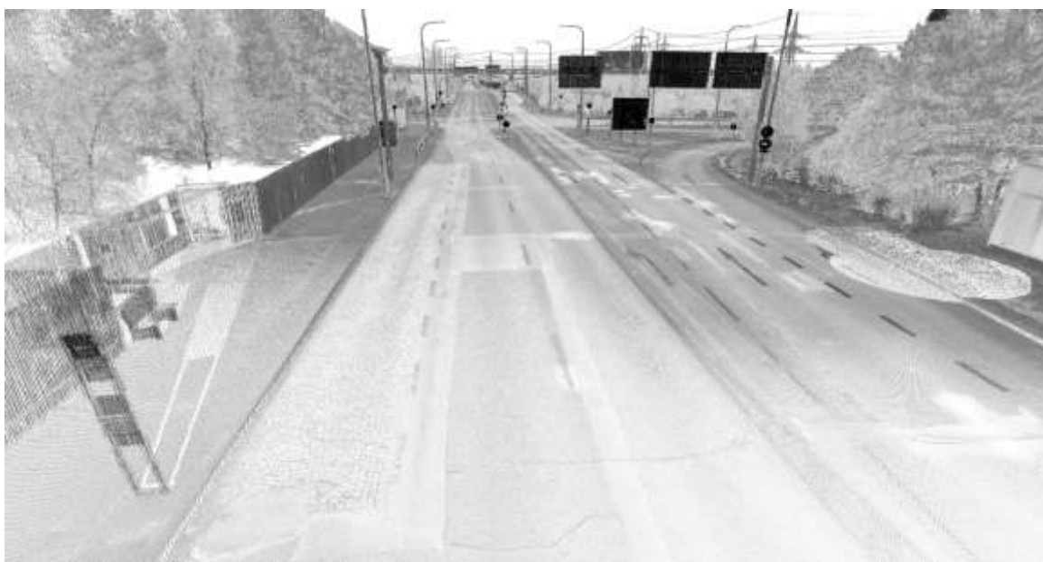
Obrázek 1 - Výsledek měření laserového skenování stop&go - mračka bodů s hustotou víc než 2000 bodů na 1m 2 s polohovou přesností mračen bodů 2 cm a se směrodatnou výškovou odchylkou do 3 mm
