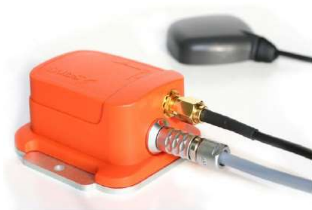
Obrázek 5. Xsens MTi-G akcelerometr (oranžový) a GPS-přijímač (černý) společnosti Roadscanners Central Europe, s.r.o.
