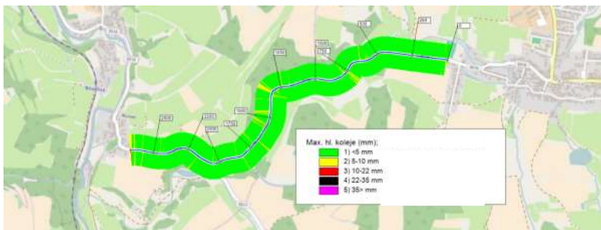
Obrázek 25. Zobrazení max. hloubky koleje v mm zatříděné do klasifikace dle TP 87 na mapě úseku.
