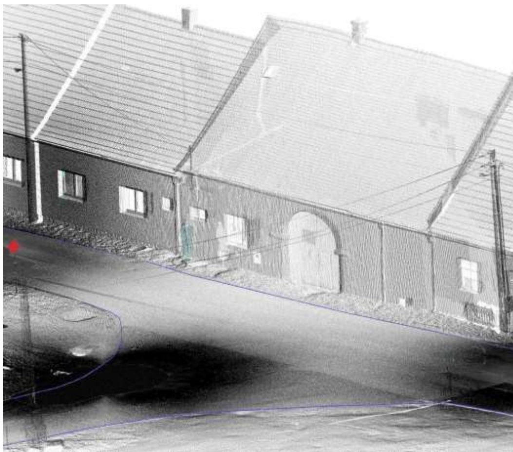
Obrázek 28. Mračno bodů – základní výstup laserového skenování a povinné spojnice kraje vozovky.
