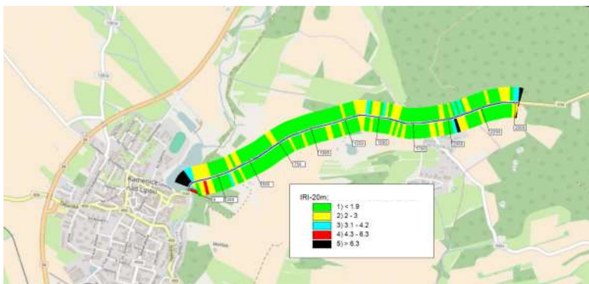
Obrázek 24. Zobrazení parametru IRI-20-m zatříděného do klasifikace dle TP 87 na mapě úseku.
