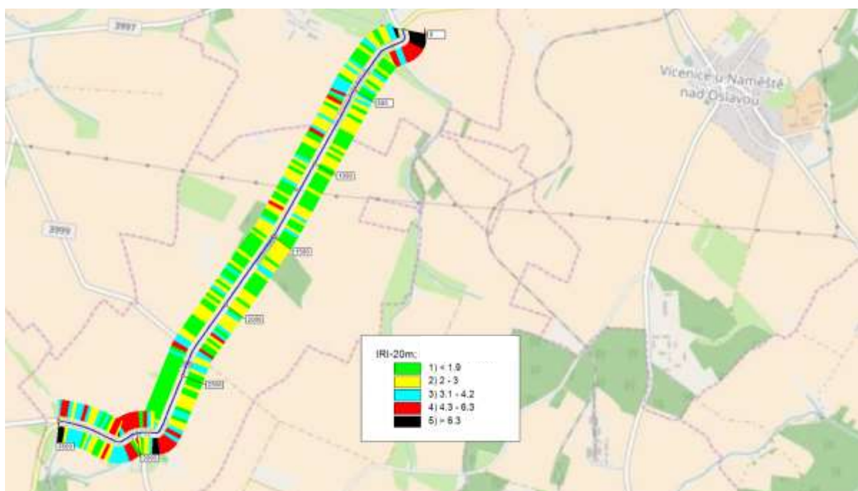
Obrázek 23. Zobrazení parametru IRI-20-m zatříděného do klasifikace dle TP 87 na mapě úseku.
