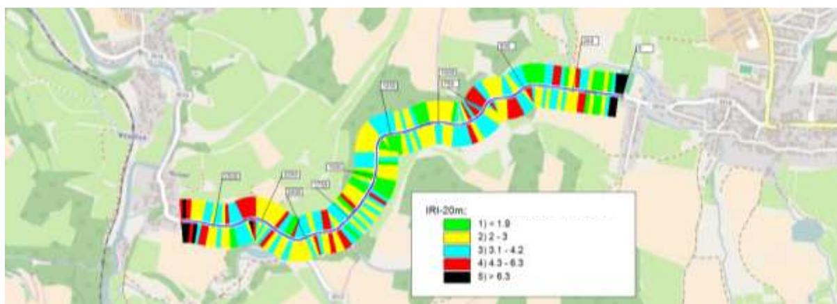
Obrázek 22. Zobrazení parametru IRI-20-m zatříděného do klasifikace dle TP 87 na mapě úseku.
