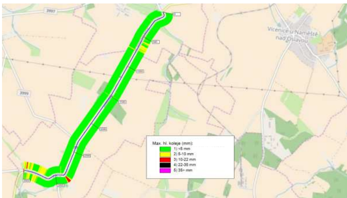
Obrázek 26. Zobrazení max. hloubky koleje v mm zatříděné do klasifikace dle TP 87 na mapě úseku.
