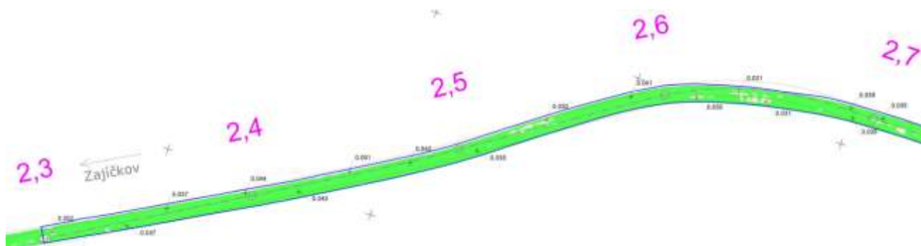
Obrázek 35. Rozdílový model – červeně jsou označeny místa, kde projektovaná tloušťka není dodržena o více jak 20%
