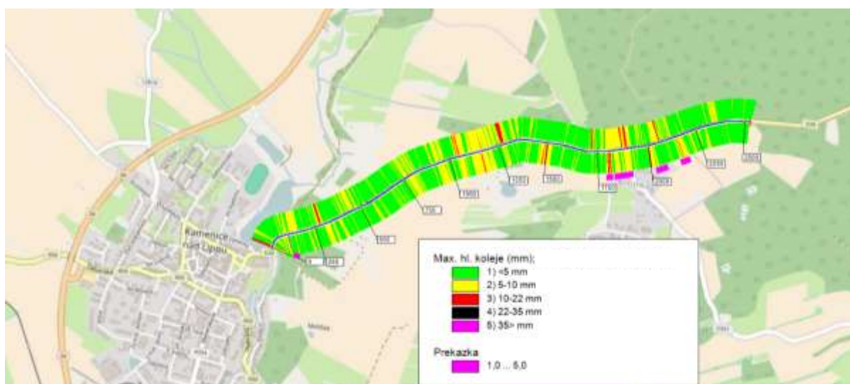
Obrázek 26. Zobrazení max. hloubky koleje v mm zatříděné do klasifikace dle TP 87 na mapě úseku.
